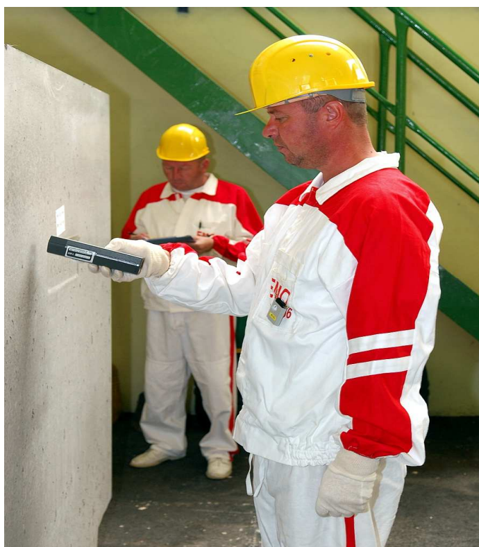
Obr. Monitorovanie rádioaktivity na povrchu vláknobetónových kontajnerov
